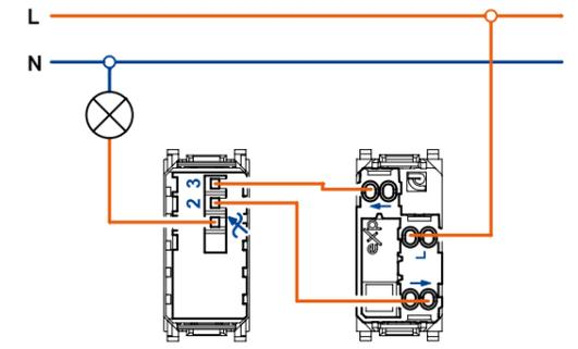
Elektronski regulator sa naizmieničnom sklopkom, povezivanje u naizmieničnom režimu rada
