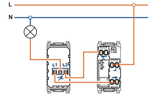
Elektronski regulator za induktivno opterećenje, povezivanje u naizmieničnom režimu rada
